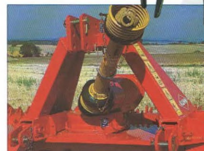
大底座和两个加强臂，确保了 HRB 403 系列动力驱动耙的坚固耐用性
