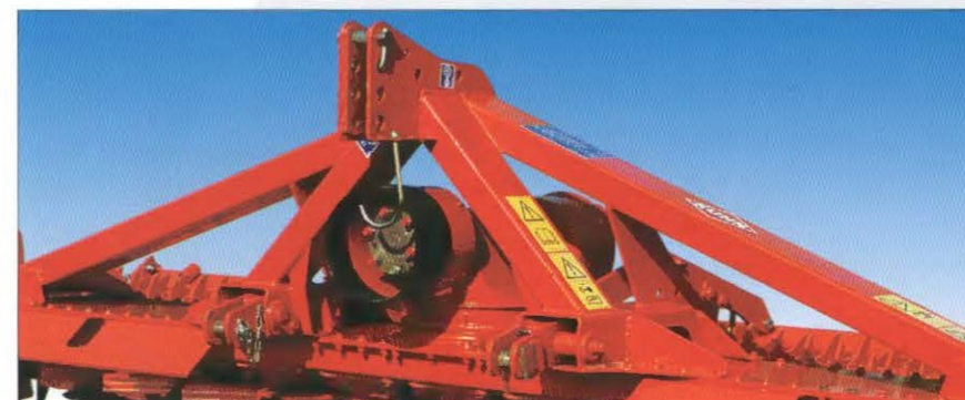
大底座和两个加强臂，确保了 HRB 403 系列动力驱动耙的坚固耐用性
