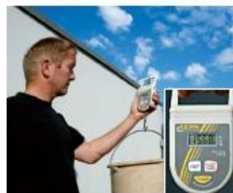
对所收集的肥料称重，并计算出新开度。撒肥机就绪。
