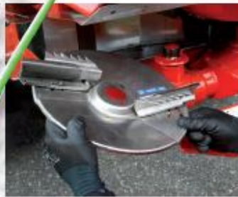
在数秒钟内无需工具即可拆下撒肥圆盘。
