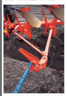
这种压力臂可用于各种犁, 允许使 用能够轻松钩住和液压推出的犁沟压平 器。在最容易发生损坏的压力臂提起钩 部分, 所有润滑嘴和液压管道都位于头 部结构内,保护效果好。在运输过程 中,压力臂可折叠起来,非常方便。
