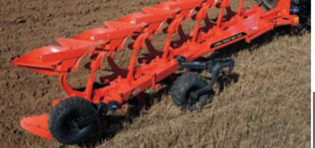
该限深轮配有一个中央枢轴,从而可随着耕深的变化而自动做出调整。可通过螺栓 1 或液压装置 2 对深度进行调节,并在每侧调节深度。沿着犁架可将限深轮安装在许多不同的位置,以实现最佳的配置性能。
