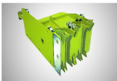
打捆活塞在滚柱式轴承上往复运动，活塞刮板用以清洁轨道，是运行平稳，打捆性能稳定。
