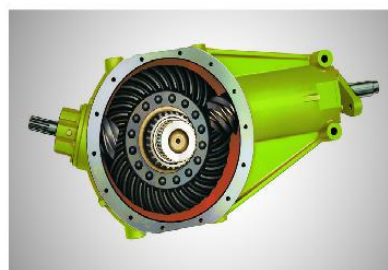
主驱动系统为准双曲面齿轮传动装置，驱动活塞做往复运动，同时驱动传动轴转动，带动喂料，打结器和打捆针工作。
