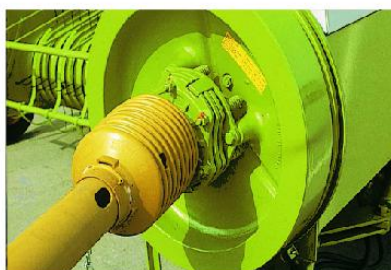
大型飞轮可缓冲打捆时的撞击，滑动离合器保护驱动系统和喂入系统以防超载。
