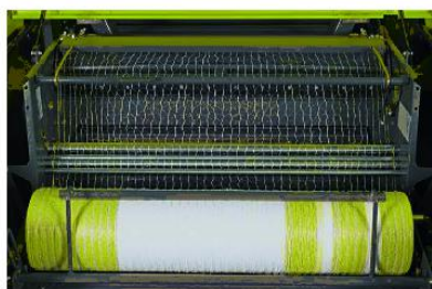
网格绑绳能完全覆盖圆捆的长度,易于运输和储存。
