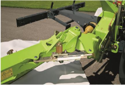
当作业遇到障碍时,过载保护装置可防止机器损坏。
