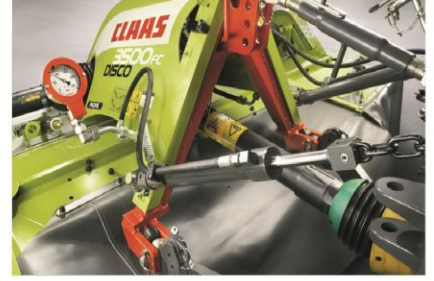
通过可选的ACTIVE FLOAT功能,您可以随时在驾驶室内调整割草机对地面的压力,使其与当前的条件相适应。
