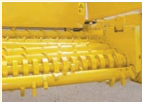
可拆换式挖掘齿条,不损伤块根的PU(聚氨酯)挡条
