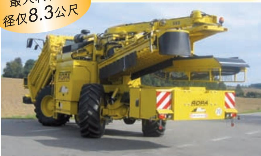
车体转向通常以方向盘控制(前轮)转弯,当车体必须进行大角度转向时,驾驶者亦可开启四轮转向模式(即前后轮同时进行转向)。此时前轮转幅可达30度,而后轮转幅更高达32度,车体完成最大转幅的直径仅8.3公尺。您可轻松驾驭Euro-Maus进出农作区的狭窄小径、畅行无阻。
