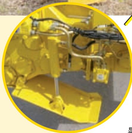
清理装置的两侧以及中间部份设置有辅助支架与平衡减压板,两者皆可透过操纵杆调节控制,以加强机身的稳定度。
