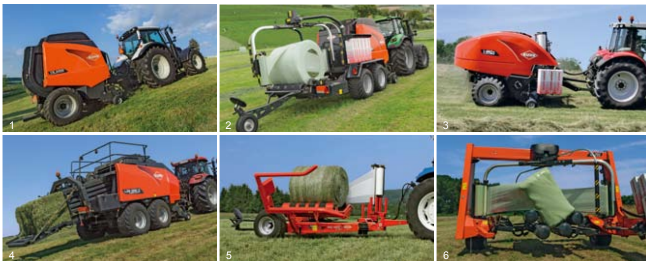
1、可调打捆室打捆机 2、可调打捆室打捆缠膜机 3、i-BIO+打捆缠膜一体机 4、大方捆打捆机 5+6、圆草捆缠膜机和方草捆缠膜机
