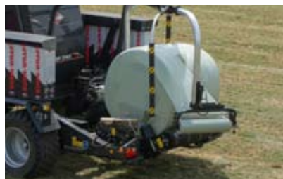
然后进一步对草捆的圆柱形表面进行缠膜，直到覆盖大约 80% 。
