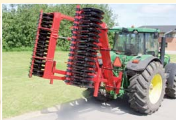
4、5 m液压折叠型机架，折叠后宽度为2.43 m。
