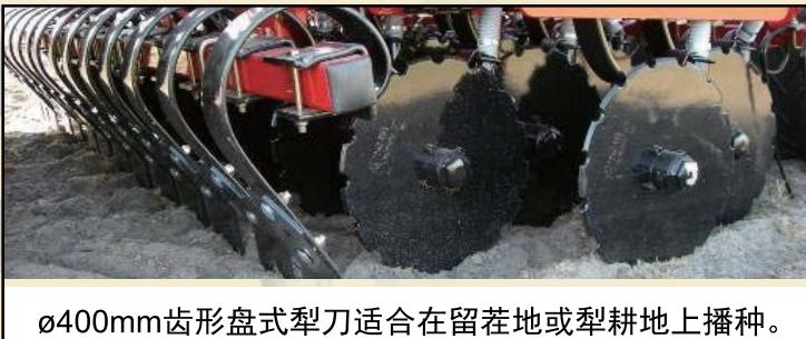
ø400mm齿形盘式犁刀适合在留茬地或犁耕地上播种。
