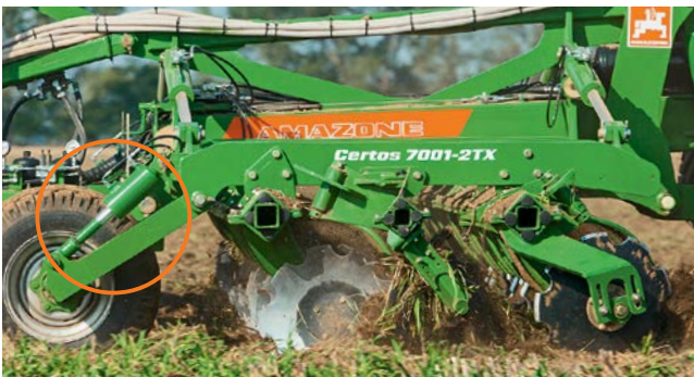
在驾驶室座位上可以通过液压方式无级调整作业深度，
