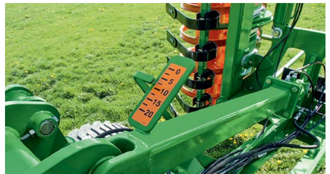
且作业深度在驾驶室内轻松可见，故可随时监控作业深度。
