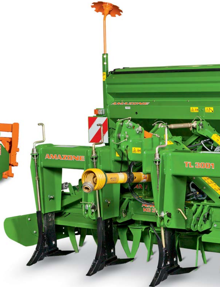
AD 条播机与 TL 深层松土机、KG 动力耙与 KW 楔环滚压轮配合使用
