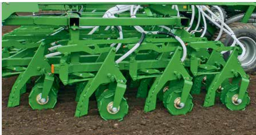
犁刀单元排布在纵向的 4 行交错十字构件中，这样间距更大，且秸秆的通过率更好。
