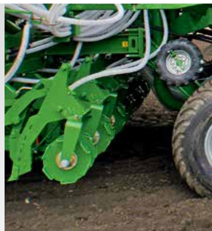
处于运输位置的阿玛松凿形开沟器（离地间距超过 400 毫米）
