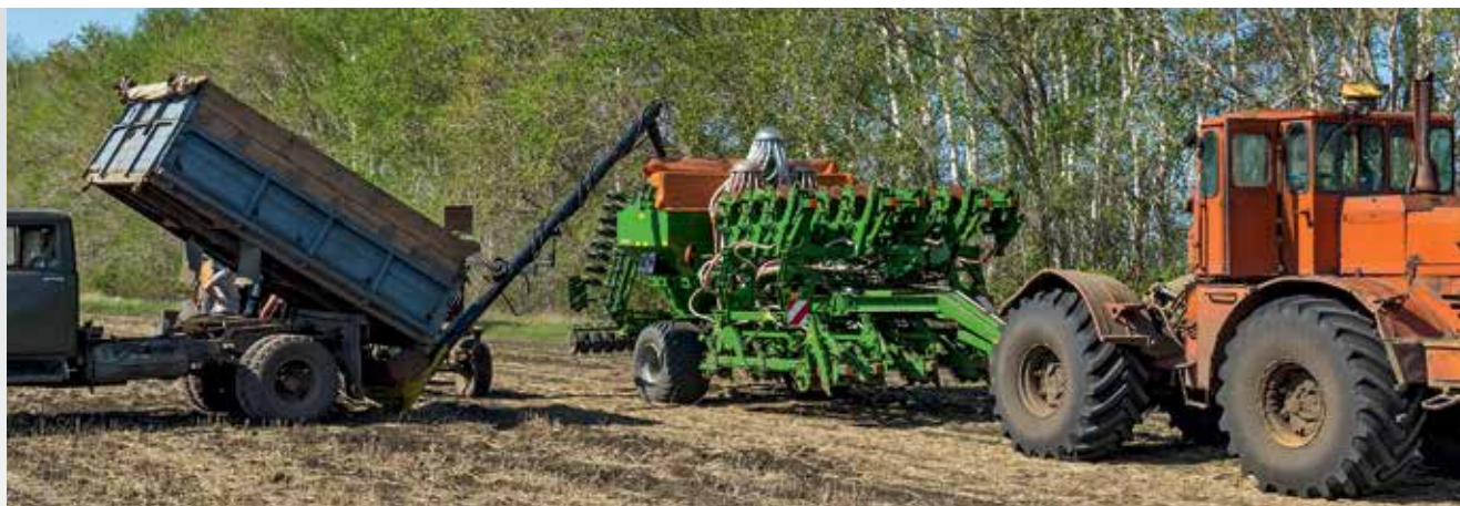
连接前置式装载机与填充蜗杆用于填充播种箱的宽开口。
