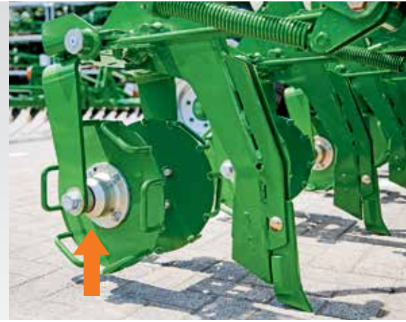
Catros 上所使用的极为耐用的免维护轴承，环形圈限深轮也有配备此类轴承。
