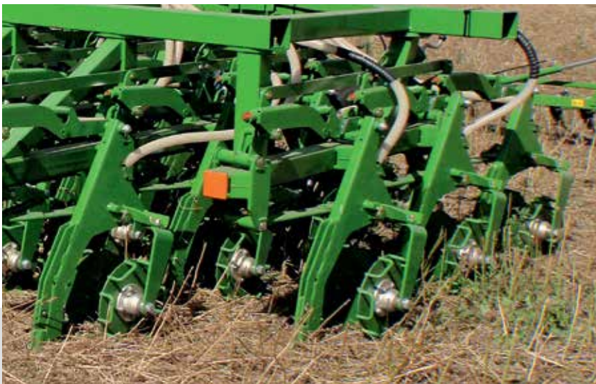
灭茬性播种与直接播种所用的环形圈限深轮
