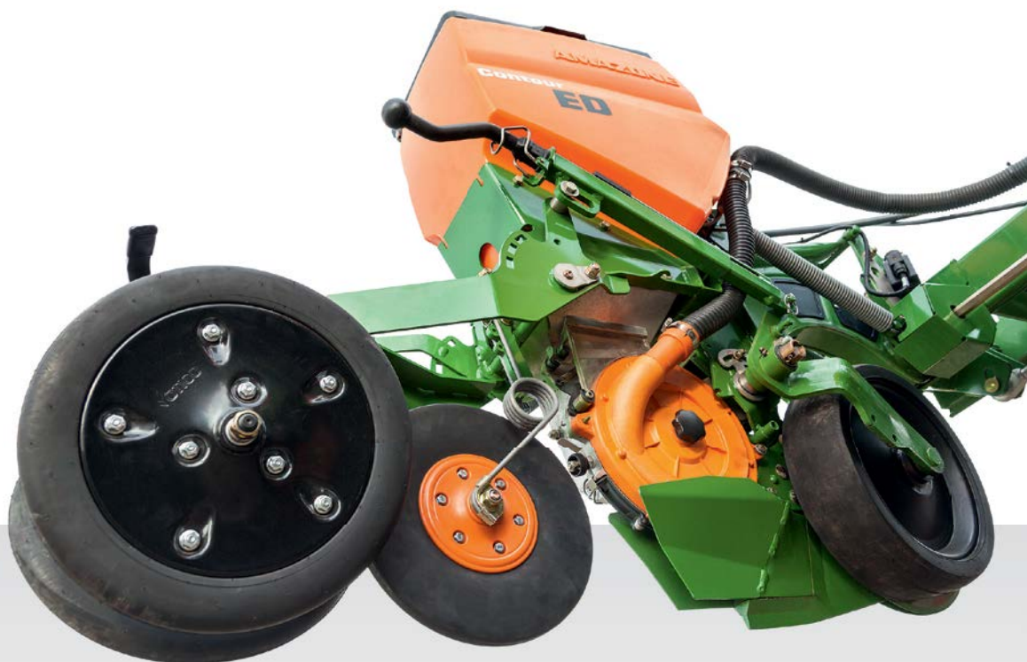
配有播种压力轮和超级 V 形压力轮的仿形播种单元
