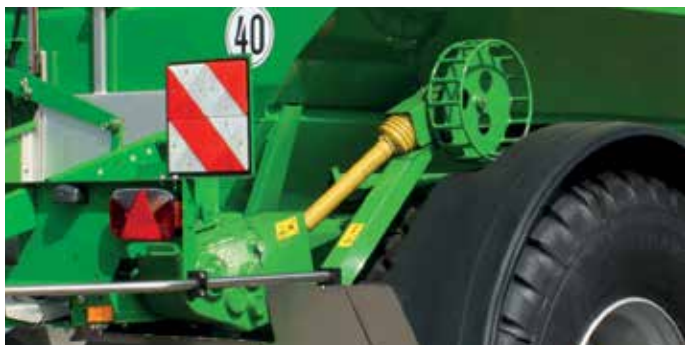
车辆的其他设备的最大允许速度为 40 公里/小时：大型警告标志和坚固耐用的挡泥板。
