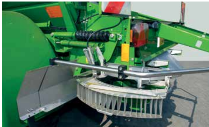
Limiter 地边施肥装置处于作业位置
