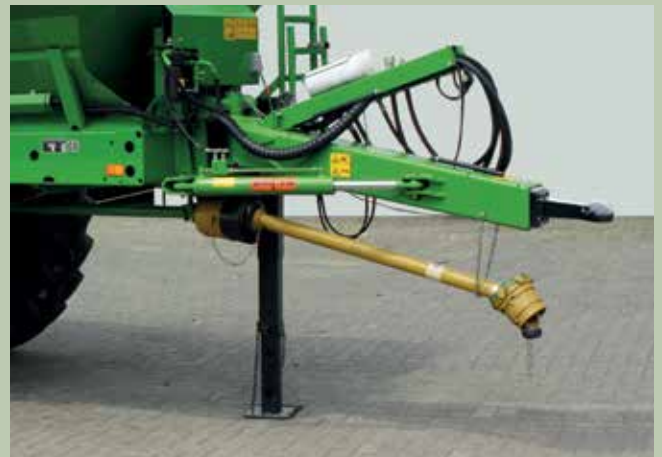
转向牵引杆（带球形接合器）
