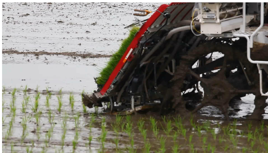
载秧台对地压与减震装置动作 视频
