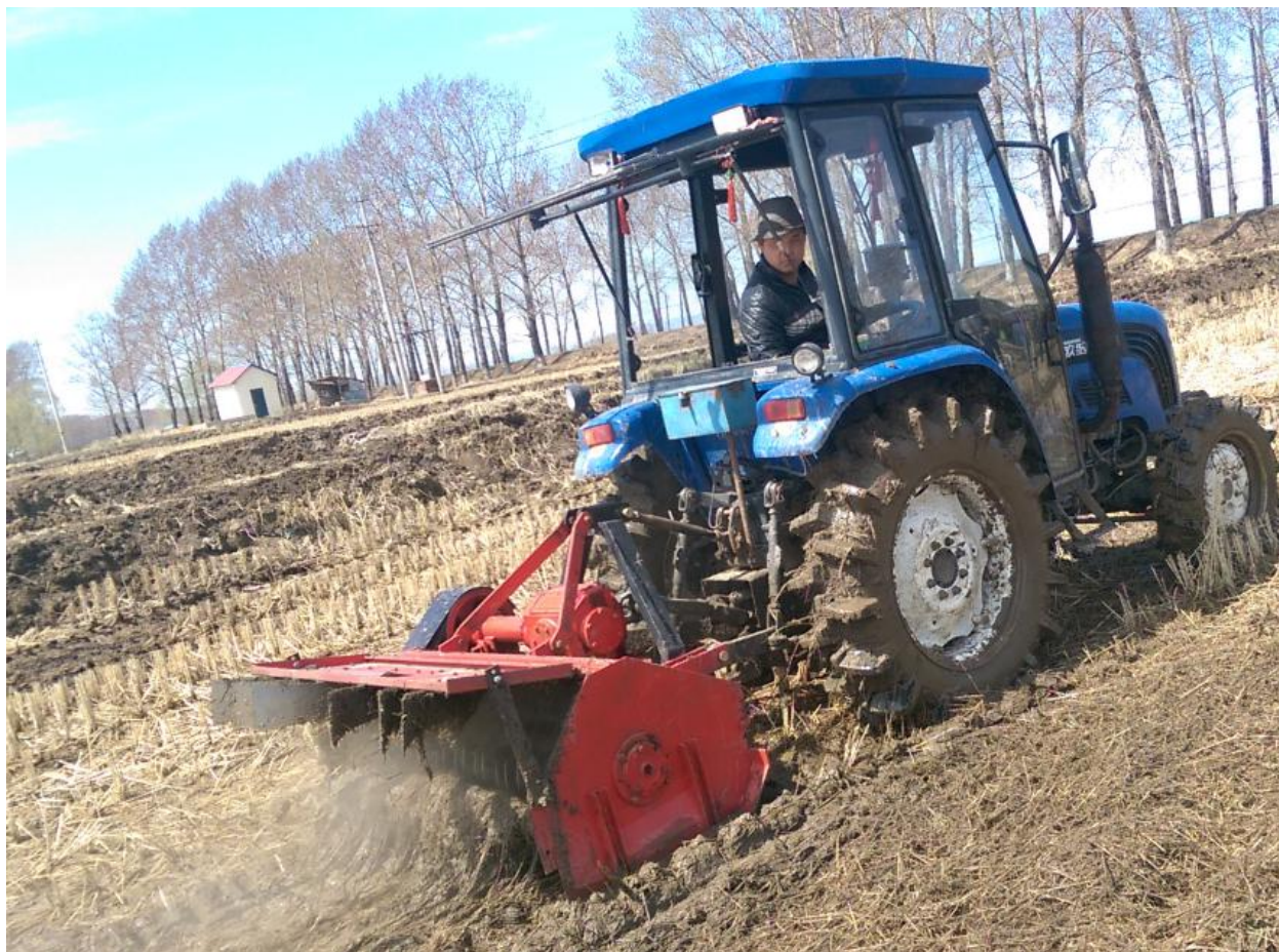
4JH-160 水稻秸秆粉碎抛撒还田机样机图片
