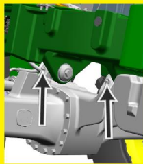
润滑机械前轮驱动前桥枢轴销 (前桥中间) ①
