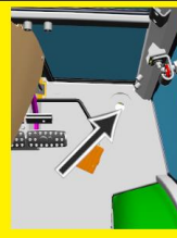
检查驾驶室安装螺栓
