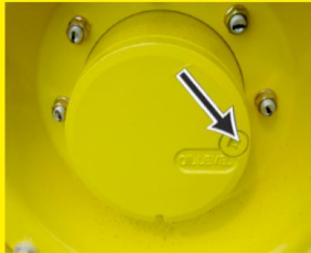
检查机械前轮驱动车桥轮毂油位
