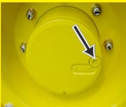
更换机械前轮驱动车桥轮毂油
