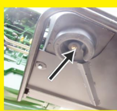
排空燃油箱中的水和沉积物 (燃油箱下侧)
