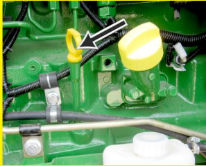
检查机油油位 (发动机左侧)
