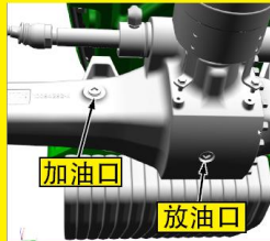
更换机械前轮驱动车桥壳体油 (前桥下侧)
