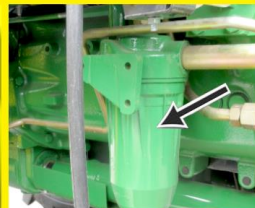
更换变速箱滤清器 (变速箱右侧)
