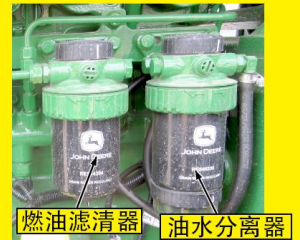
排空燃油滤清器和油水分离器中的水和沉淀物 (发动机右侧)
