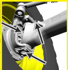
润滑机械前轮驱动前桥转向主轴 润滑机械前轮驱动前桥 (前轮内侧) ①
