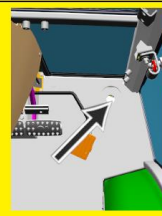
检查驾驶室安装螺栓
