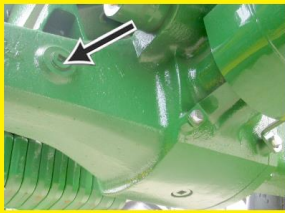
检查前桥壳体油位 (前桥下侧)
