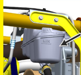
检查冷却液液位 (风扇上方)
