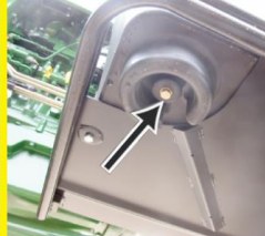
排空燃油箱中的水和沉积物 (燃油箱下侧)
