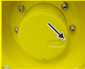
检查机械前轮驱动车桥轮毂油位
