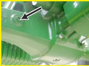
检查前桥壳体油位 (前桥下侧)
