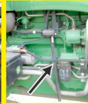
清洁发动机曲轴箱通气管 (发动机右侧软管)
