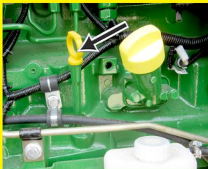
检查机油油位 (发动机左侧)
