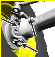
润滑机械前轮驱动前桥转向主轴 润滑机械前轮驱动前桥 (前轮内侧) !
