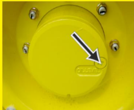
更换机械前轮驱动车桥轮毂油
