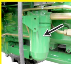
更换变速箱滤清器 (变速箱右侧)
