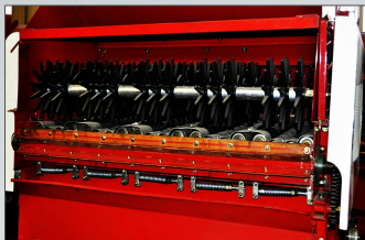
人体仿生学原理，指型压送装置，5组20辊同步开动，柔性剥皮技术，提速作业效能品质。
