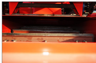
升运器加宽至600，38节距升运链，每个附件旁边有备用附件，提高可靠性，整机通畅性更好
