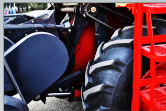
四连杆铰接结构，割台角度随心调节，收割效果完美无缺。
