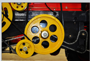
杂余主动轴皮带轮，加装安全离合器，增配负载报警器，保护输送带、搅龙等零件，使用安全更耐用。
