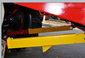
捡拾台持续革新，双安全卡固定保护，防止割台偏斜，操作灵活自如。
