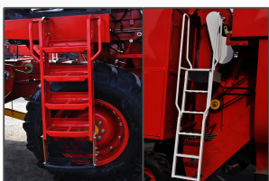
新颖前梯设计，全新工程梯设计，结构稳固安全，方便维护保养。
