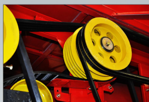
主离合迭代更新，三联带升级四联带，传动效率节节攀升。
