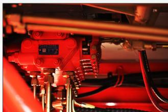
多路阀卸粮部分升级，增加双锁结构，有效预防卸粮筒自转，操作安全性更高。
