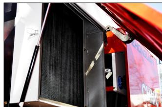
优化水箱材质，水箱散热带采用大波距，通透性更强，散热性更好。
