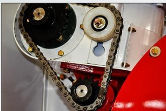
粮仓卸粮链轮，由17齿改为15齿，工艺日趋先进，提高立搅龙转速，缩短卸粮时间，提升机械作业效能。
