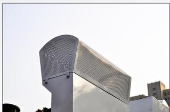
优化水箱护网罩结构，精密测算网眼规格，有效防止水箱堵塞，解决发动机聚热高温问题。
