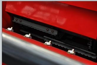
过桥主被动轴链轮，由普通件改为精铸件，材质更加精良，精密程度更高，实用性更好。
