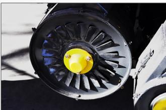
优化复脱器结构，采用业界领先的侧面搓板式，增强麦粒复脱能力，实用性与效果显著提升。
